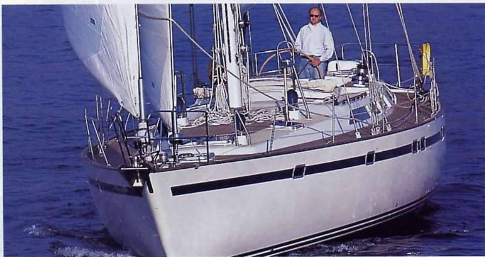
Da questa foto si può notare la notevole larghezza del Taswell 56', che rimane tale anche sul galleggiamento. Ciò conferisce un'elevata stabilità di forma, che sommata alla percentuale di zavorra del 40%, riduce al minimo lo sbandamento e dà una buona potenza sotto vela.
