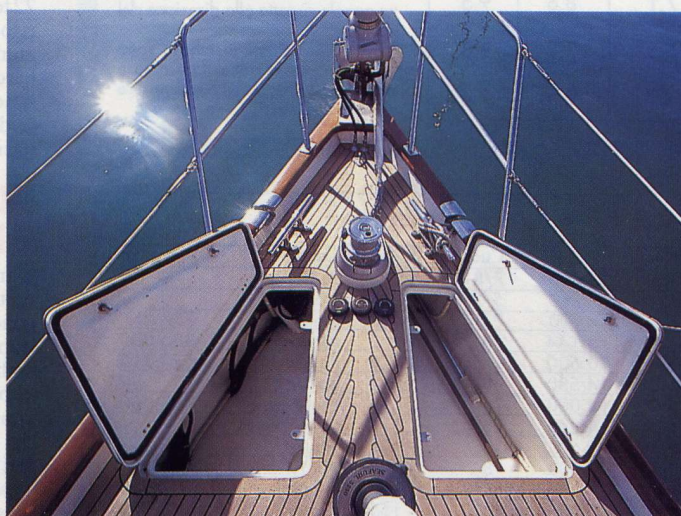
La cala dell'ancora è sdoppiata, molto larga e non troppo profonda, per posizionarvi la seconda ancora e la relativa cima. Il verricello di serie è da 3500 Watt. Da notare la qualità delle finiture in teak.
